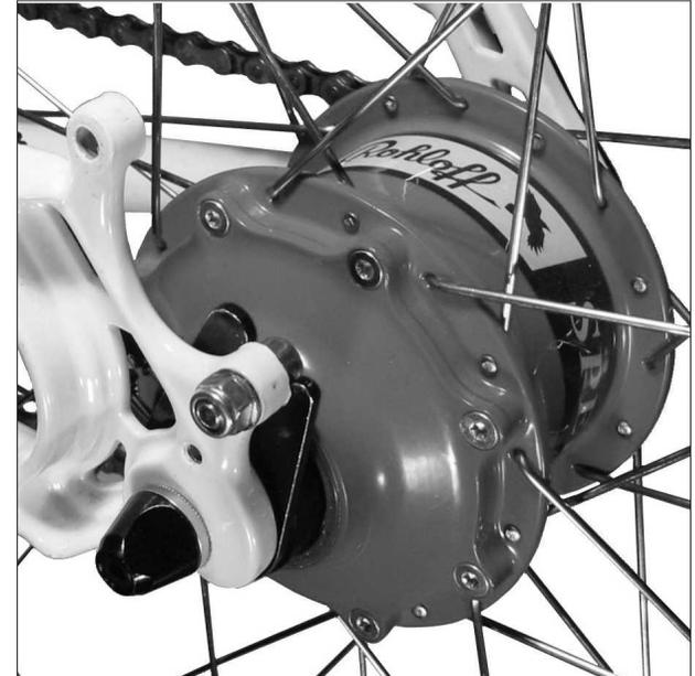
*Rohloff SPEEDHUB 500/14 CC OEM2 monté avec boulon d'appui*
