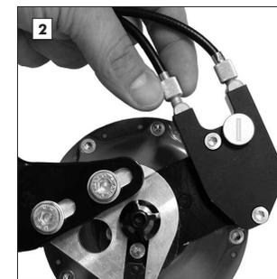
Sur les versions à commandes par câbles internes, les molettes de réglage de tension des câbles se trouvent sur le boîtier de câble, côté tasseau de frein gauche ou de la base gauche du cadre.
